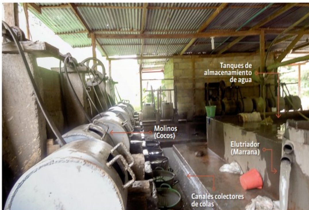
Figura 3. Principales elementos de un entable típico. Fuente: Grupo MAPRE.
