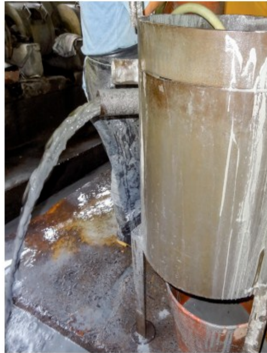
Figura 4. Elutriador (marrana) en funcionamiento con mercurio derramado.
