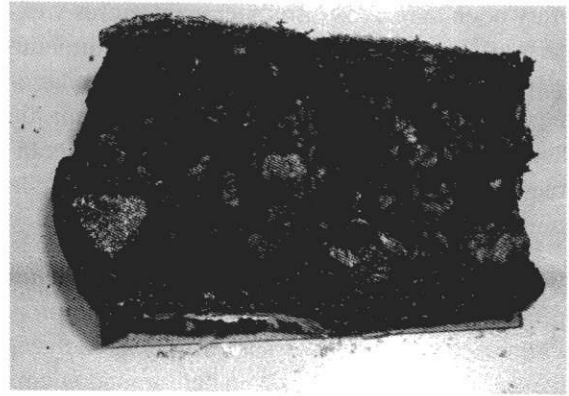
Figura 3 Aspecto esponjoso del interior de un sistema intumescente, después del ensayo Meker
