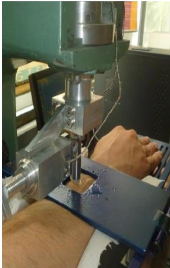
Figura No. 27 montaje de prueba en esclerómetro
