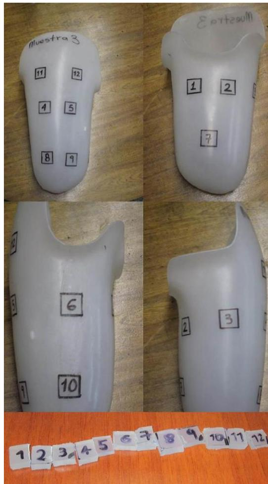
Figura No. 21: Probetas analizadas y *sockets* de los cuales fueron tomadas
