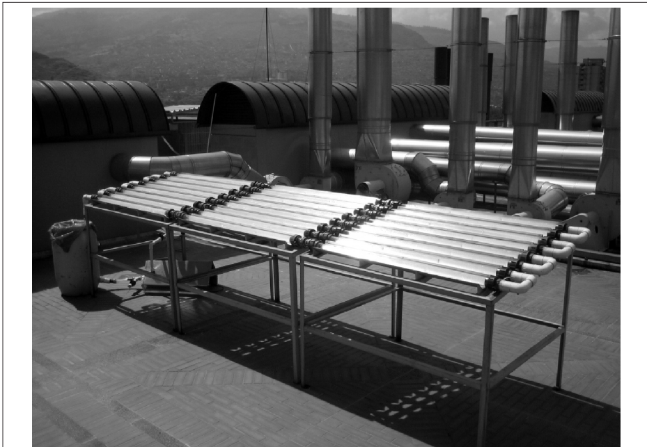
Figura 1. Colector solar empleado en la degradación de malatión, ubicado en la Sede de Investigaciones Universitarias (SIU) de la Universidad de Antioquia.
