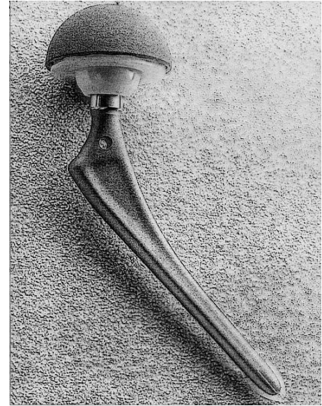
Figura 1 Materiales utilizados en una prótesis total de cadera no cementada: al vástago metálico (de aleación Ti 6Al 4V, cobalto cromo) se inserta una cabeza esférica de cerámica de alta tenacidad (zirconia estabilizada con itrio o alúmina dopada). El acetábulo es de polietileno de alto peso molecular del tipo UHMWPE. Dicha prótesis es adherida al hueso con cemento de polimetilmetacrilato (PMMA)
