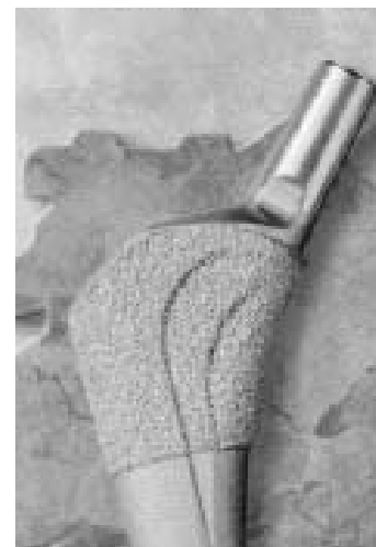
Figura 2 Detalle de una prótesis no cementada. Se observa el recubrimiento del vástago de Ti 6Al 4V con hidroxiapatita rociada térmicamente, para permitir su adherencia al cortical del fémur
