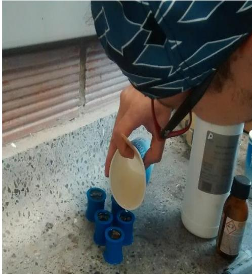
**Foto 3. Preparación de los moldes con resina epóxica. Fotografía tomada por Natalia Restrepo. Laboratorio de Ingeniería de Materiales, Universidad de Antioquia.**
