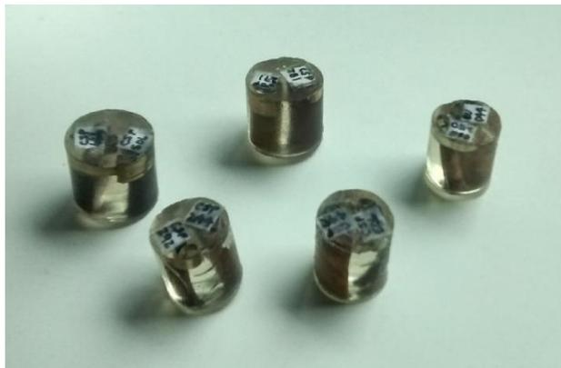
**Foto 4. Bloques de resina desmoldados, con muestras debidamente rotuladas. Fotografía tomada por Natalia Restrepo. Laboratorio de Ingeniería de Materiales, Universidad de Antioquia.**
