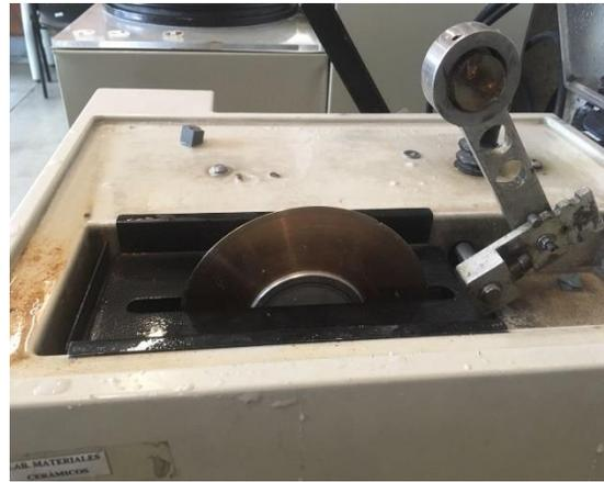
Foto 5 y 6. Cortadora Isomet 1000. Fotografía tomada por Natalia Restrepo. Laboratorio de Ingeniería de Materiales, Universidad de Antioquia.
