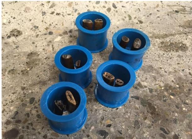
Anexo 3. Cortes de costillas en los moldes listos para embebido. Fotografía tomada por Natalia Restrepo. Laboratorio de Ingeniería de Materiales, Universidad de Antioquia.
