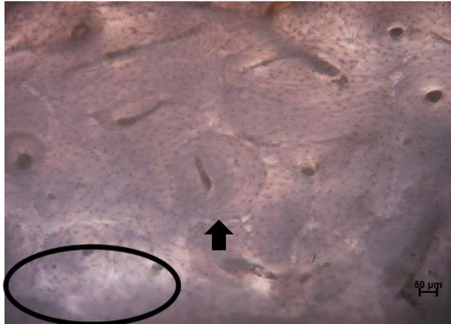
Anexo 4.1 Fotomicrografía con microscopio fotónico con objetivo 20 X Muestra CSP 244. Señala línea de cemento. Encierra hueso entretrejido. tomada por Natalia Restrepo. Laboratorio de Ingeniería de Materiales, Universidad de Antioquia.
