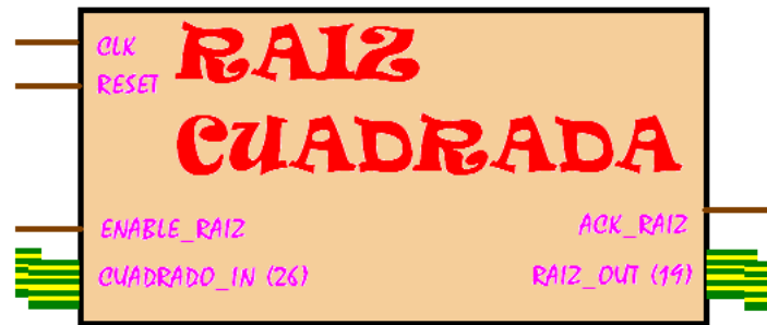
Figura 7.17: Módulo VHDL para el cálculo de la raíz cuadrada de un número.
