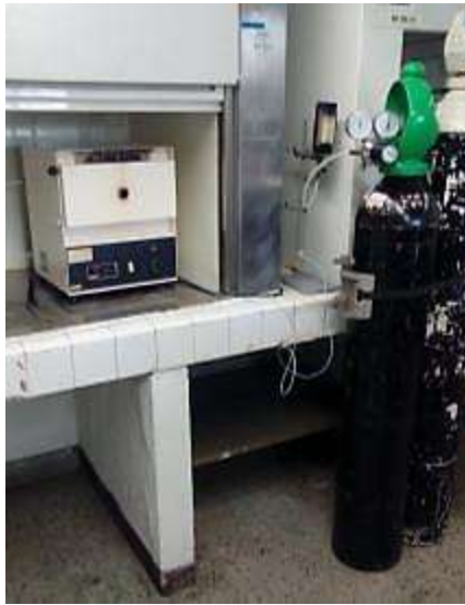
Figura 3. Reactor para la carbonización (pirólisis) y activación química de los EE.
