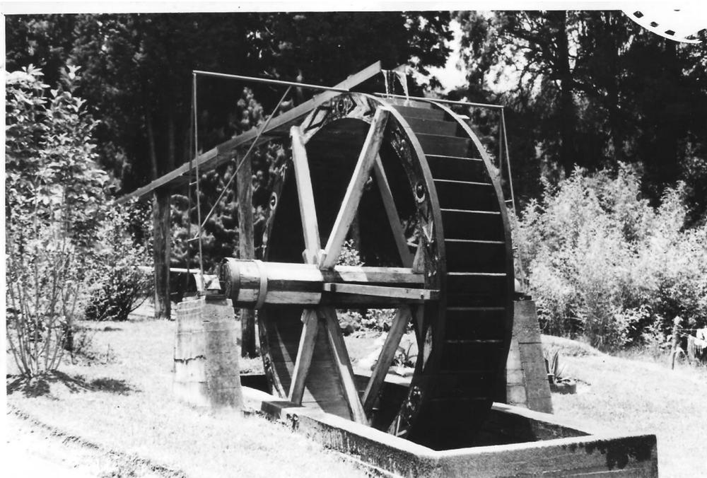
**Figura 8.** Foto de rueda de “cajones” utilizada en industria carmelitana de cerámica y movilizada mediante corrientes de agua.
