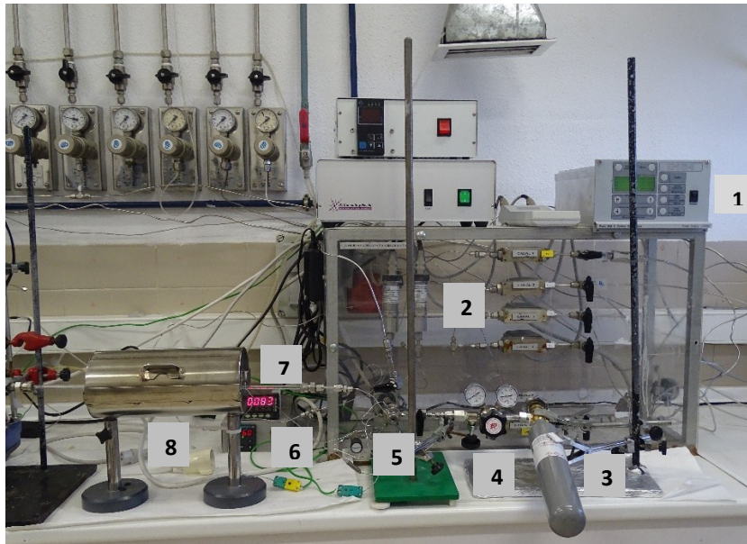
Figura 2-1. Montaje experimental para los experimentos empleando pulsos de ^{13}\text{C}^{18}\text{O}_2
