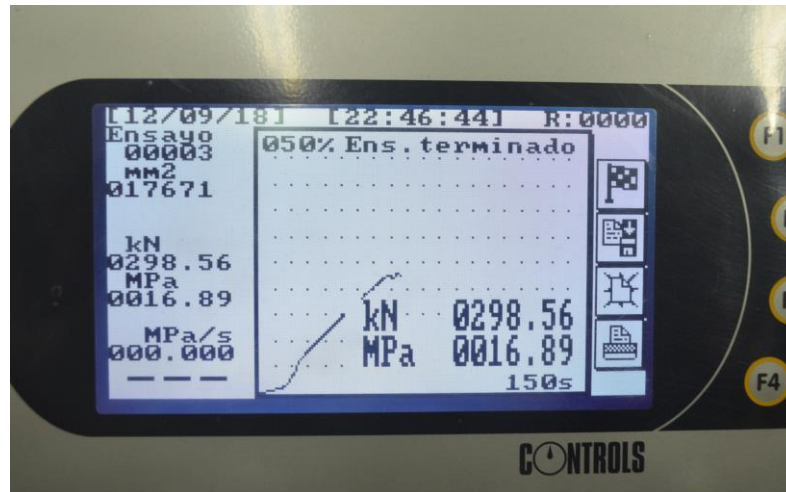
Figura 39. Resultado mostrado por el dial para un cilindro (fuente propia).
