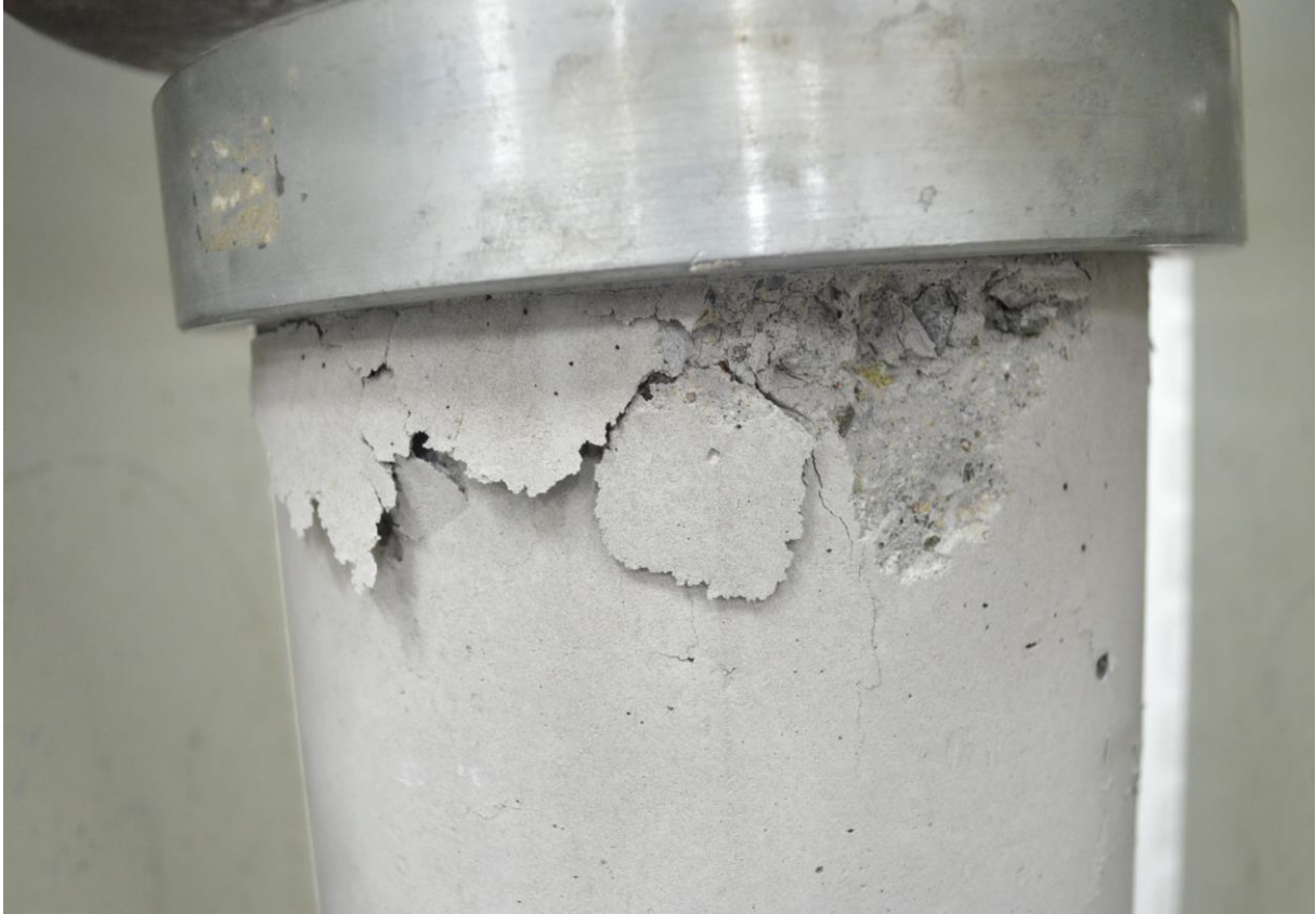
Figura 51. Cilindro fallado a los 28 días ensayo compresión simple, falla por agregado (fuente propia).
