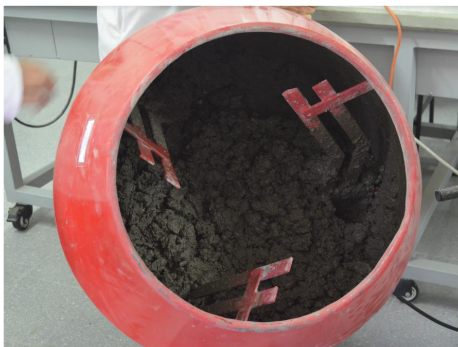
Figura 16. Mezclado del cemento, arena, grava y agua (Fuente propia).
