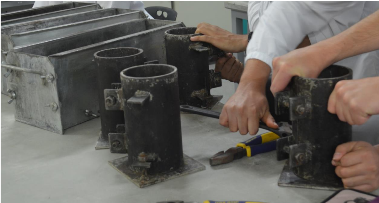
Figura 45. Armado y lubricación formaleta metálica de vigas y cilindros testigos (fuente propia).
