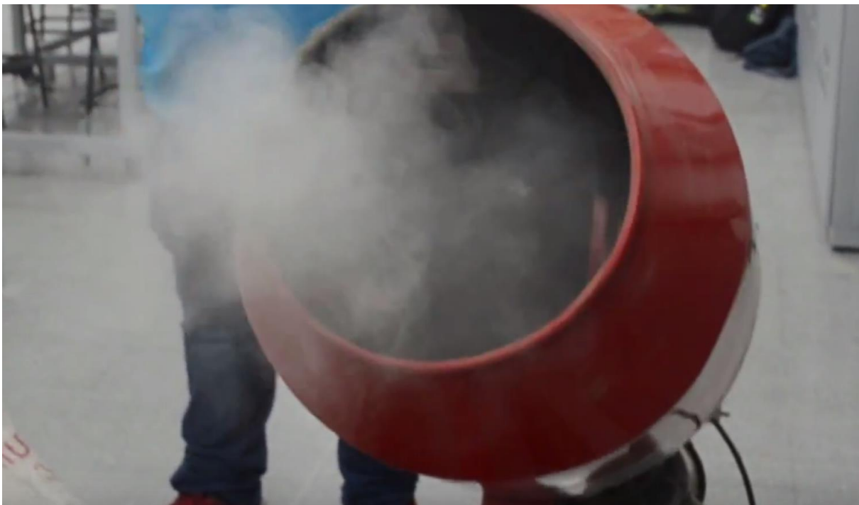
Figura 46. Agregado grueso, porción de agua y cemento mezclándose en la concretadora (fuente propia).
