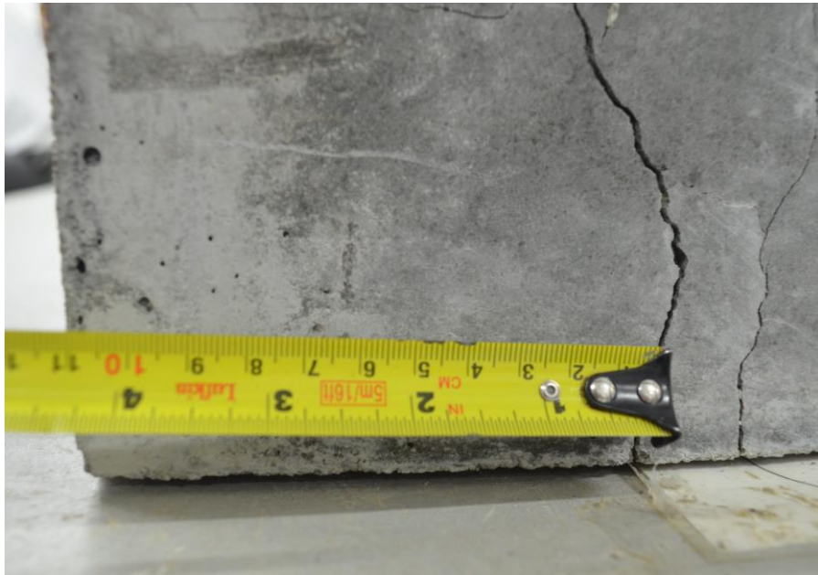
Figura 25. Medición de la posición y la distancia entre fallas (fuente propia)
