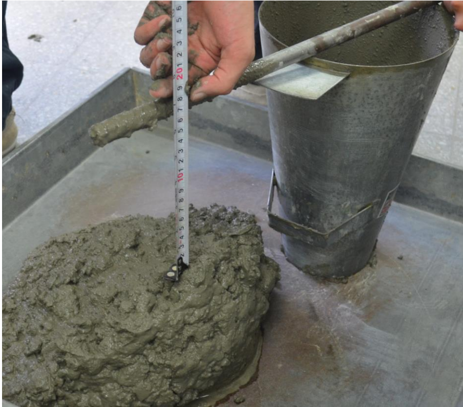
Figura 47. Ensayo de asentamiento para medir manejabilidad (fuente propia).
