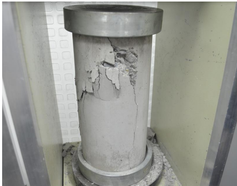
Figura 19. Cilindro fallado en ensayo de compresión simple (fuente propia).
