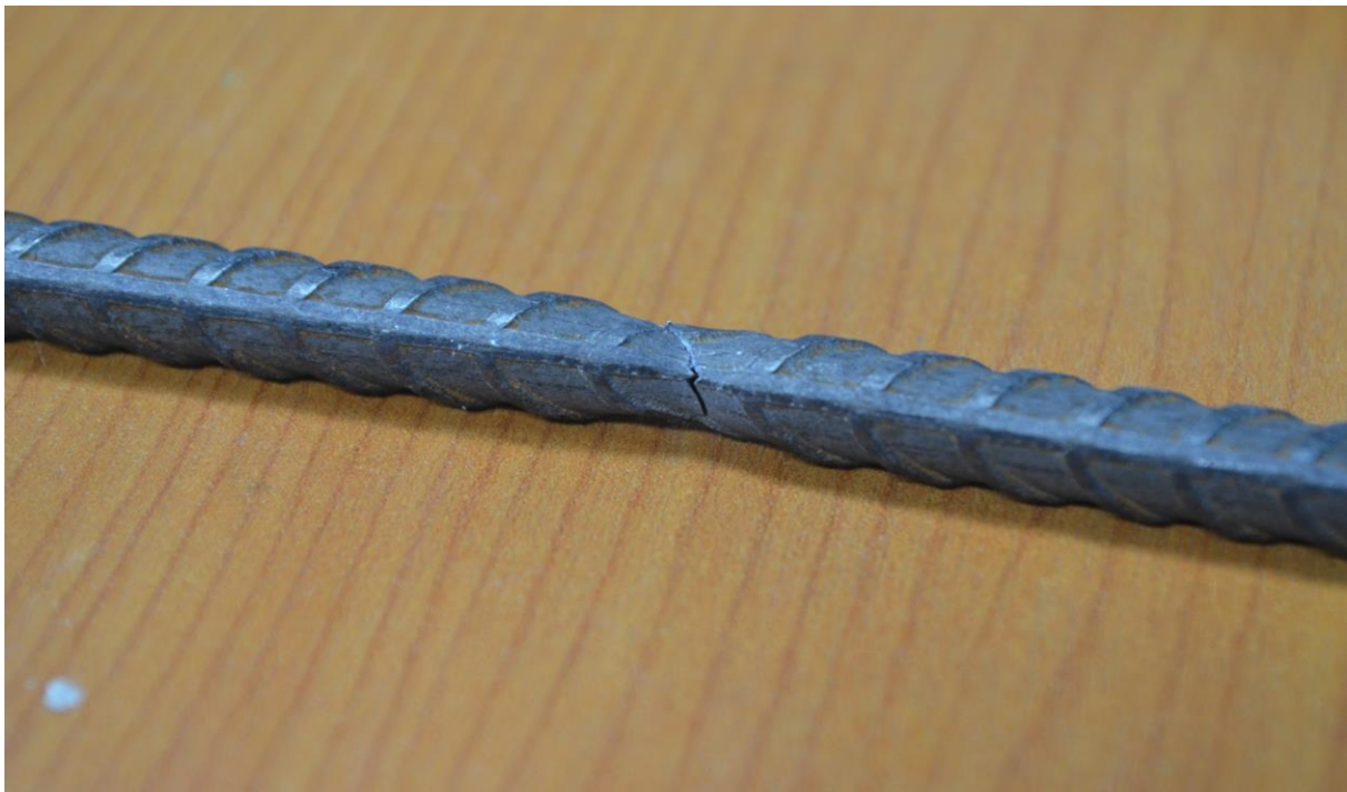
Figura 44. Falla del acero en el ensayo a tensión, con pocas deformaciones y poca ductilidad (fuente propia).
