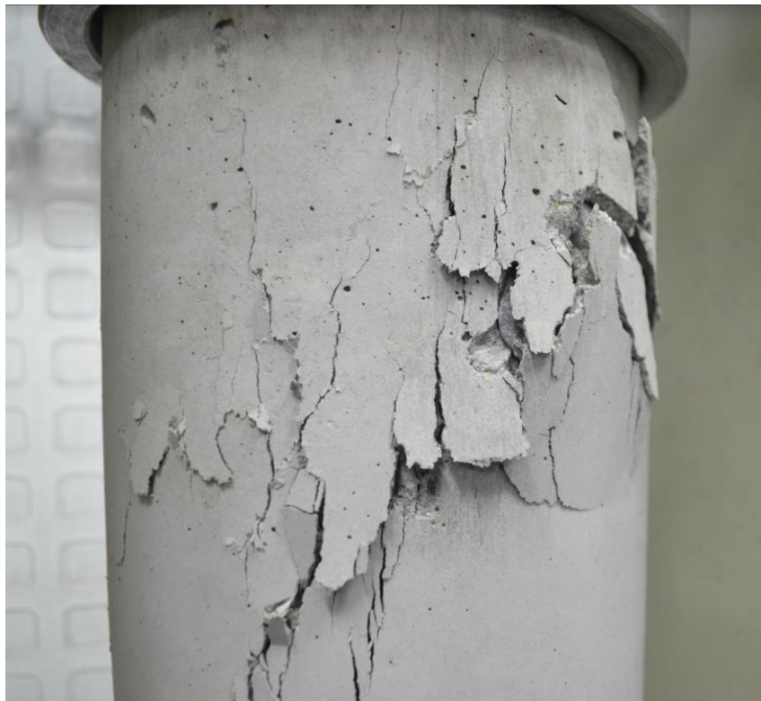
Figura 50. Cilindro fallado a los 28 días ensayo compresión simple, falla por Poisson (fuente propia).
