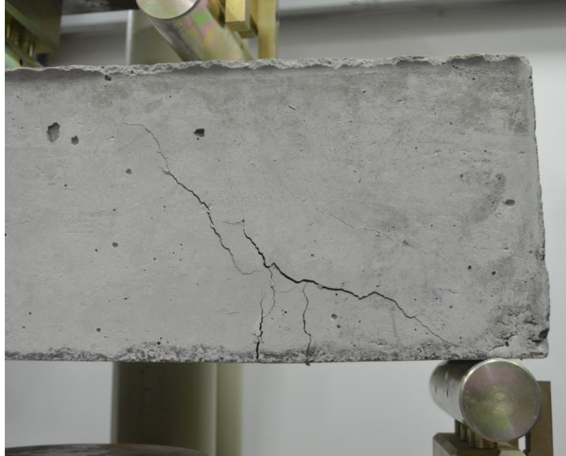
Figura 22. Agrietamiento típico falla a cortante con ángulos de aproximadamente 45 grados (Fuente propia).
