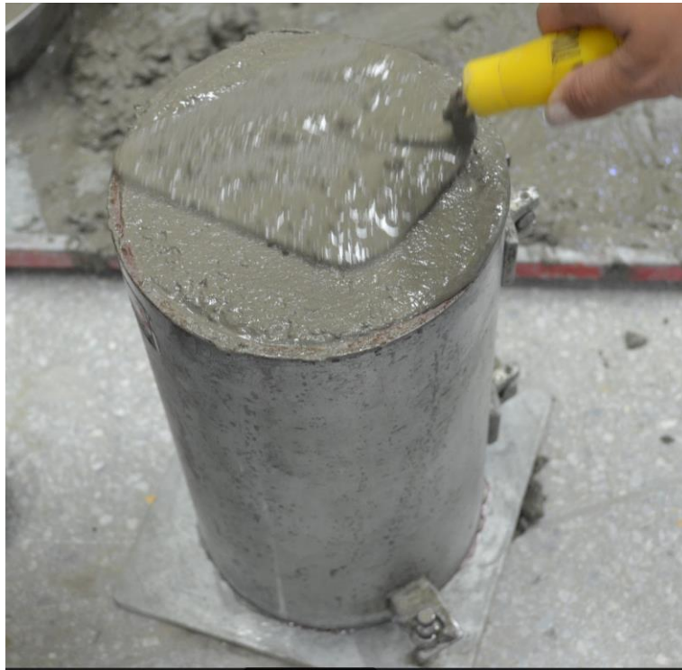
Figura 49. Vaciado cilindro testigo para el cálculo de la resistencia a los 28 días (fuente propia).
