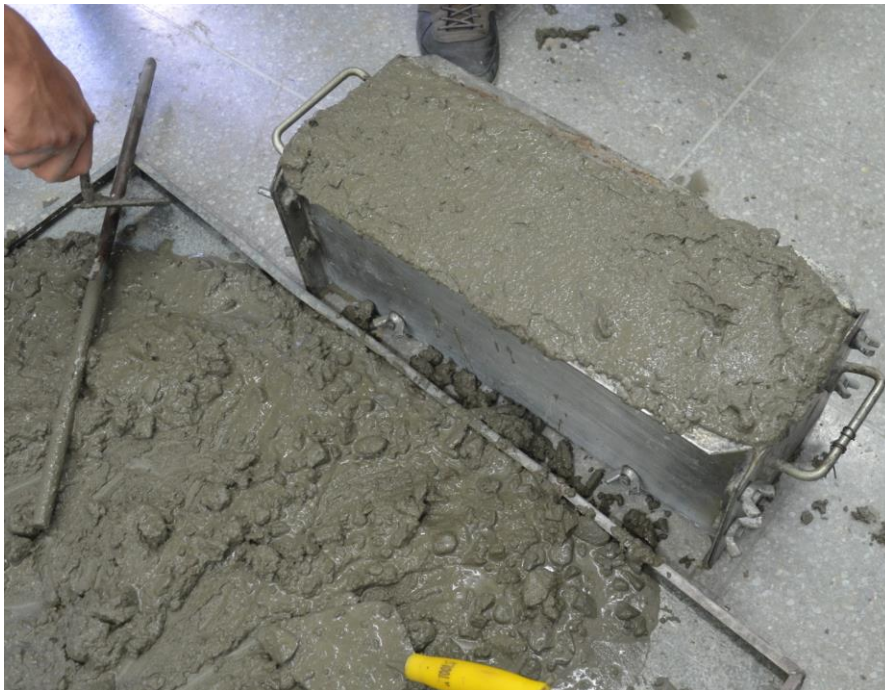
Figura 48. Viga vaciada en formaleta metálica (fuente propia).
