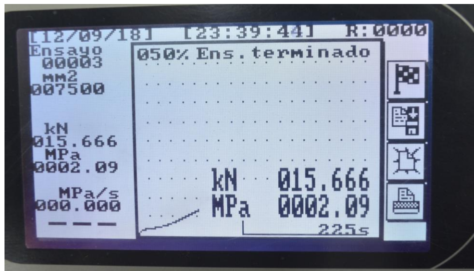
Figura 40. Ensayo a flexión viga sin refuerzo (fuente propia).
