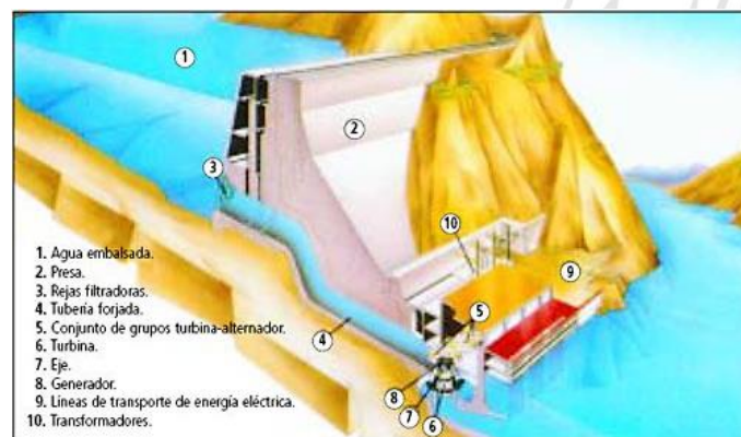
Ilustración 1. Sección transversal central típica. Tomada de: https://www.foronuclear.org/es
