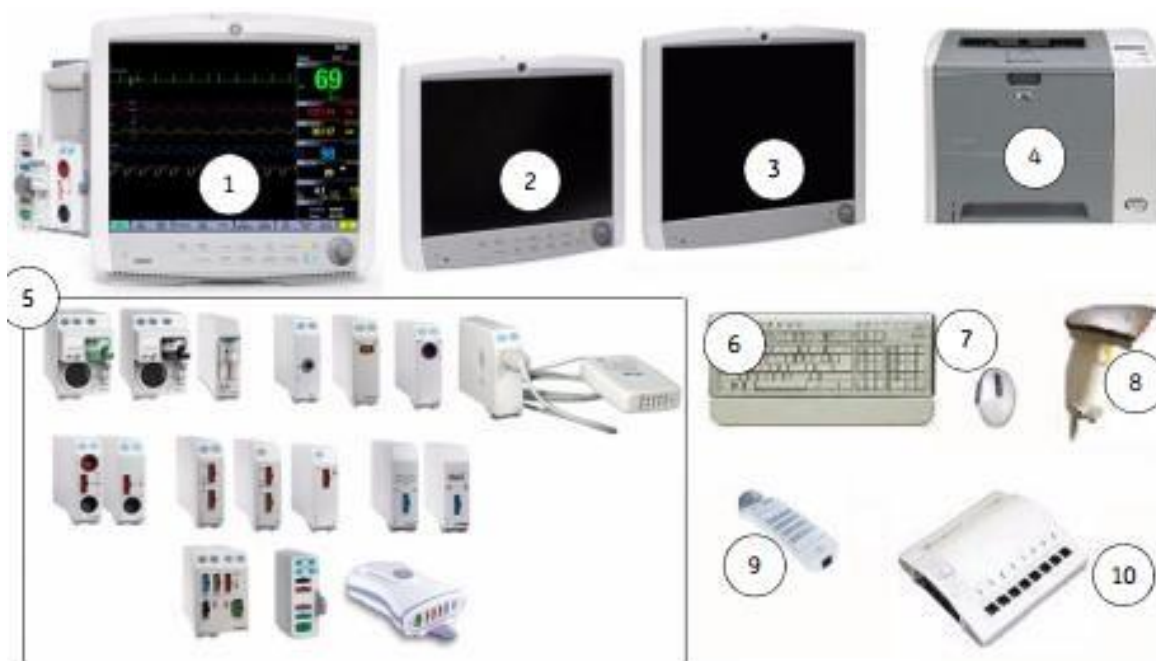
Figura1. Componentes del sistema de un monitor de signos vitales Carescape B650 GE
