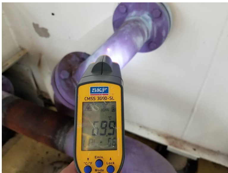
Figura 4. Medición de temperatura con termómetro SKF CMSS 3000 – SL
