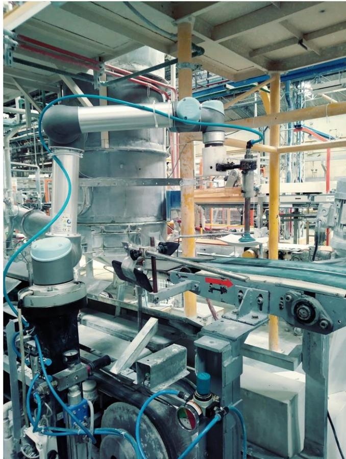
Figura 32. Transporte del plato sobre sistema de descarga.
