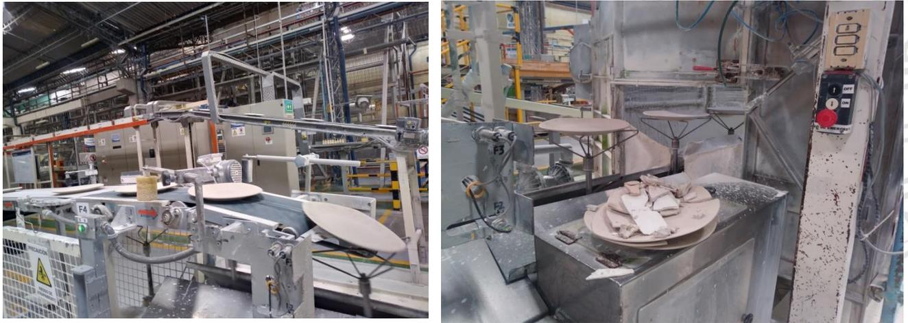
Figura 5. Transporte de platos usando soportes metálicos. [7]
