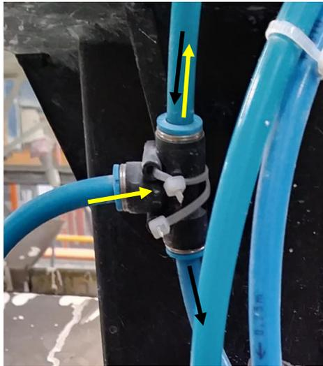
Figura 22. Acople de aire hacia entre el soplido y el vacío hacia el robot [7].
