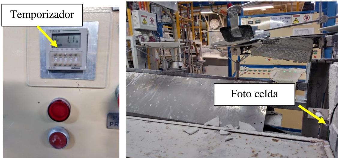
Figura 37. Sistema de seguridad esmaltadora.
