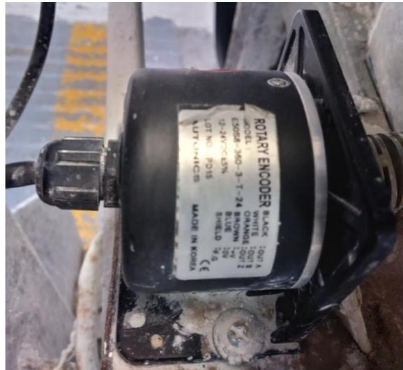
Figura 27. Encoder rotativo de 6 hilos [7].
