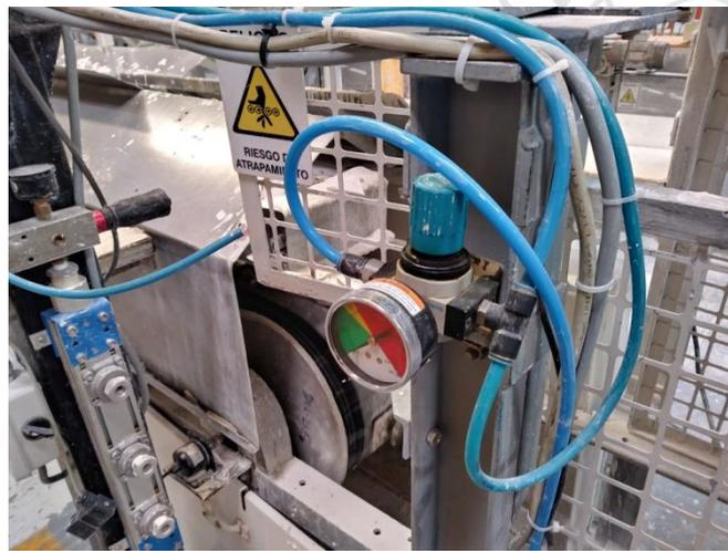
Figura 19. Regulador de presión sistema neumático robot [7].
