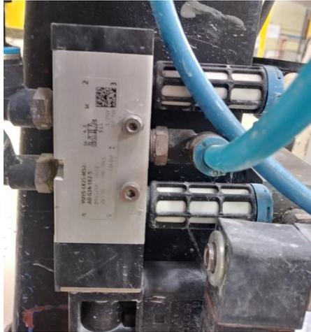
Figura 20. Electroválvula de soplido del robot [7].
