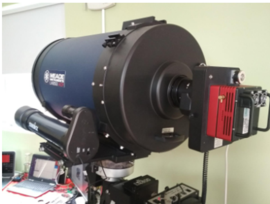
Figura 58: Montaje completo: micro-enfocador + rueda de filtros + cámara CCD en telescopio.
