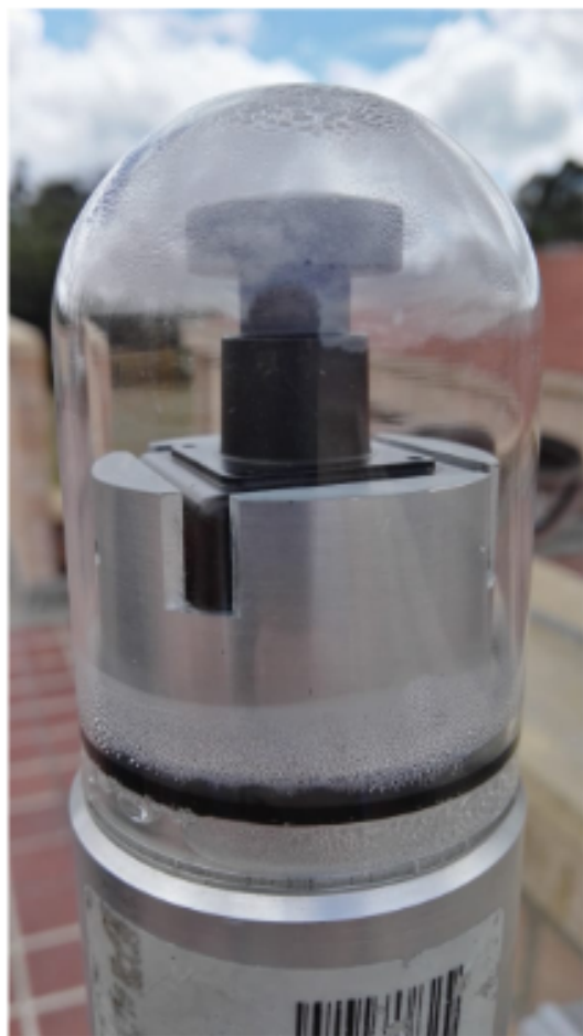
Figura 72: Problema de condensación de humedad sobre el domo de la cámara.
