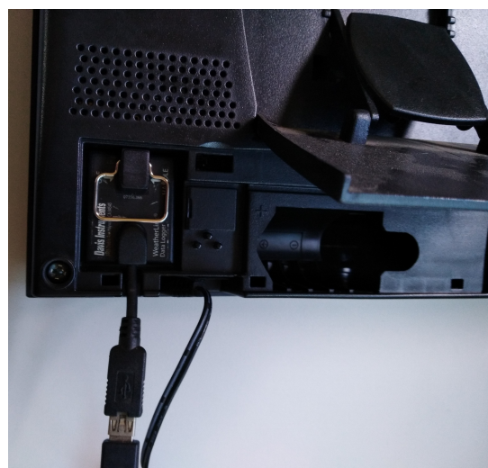
Figura 75: Interfaz de comunicación serial de la estación meteorológica.
