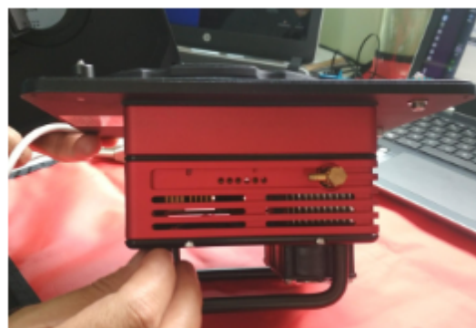
Figura 54: Vista lateral del ajuste de la rueda de filtros.
