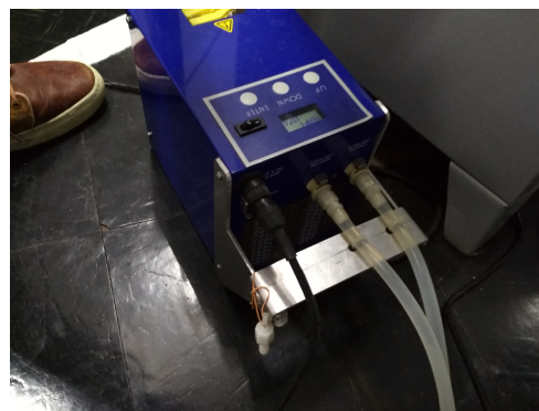
Figura 21: Refrigerador externo de la cámara CCD.
