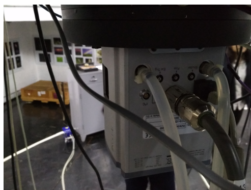
Figura 20: Conexiones de la cámara CCD, potencia en el centro, datos por cable USB del lado derecho, bajo uno de los conductos del líquido refrigerante.
