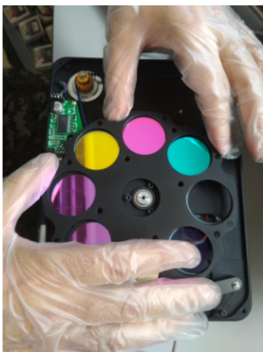
Figura 56: Instalación de los filtros.
