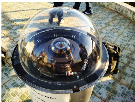
Figura 30: Cámara de cielo.
