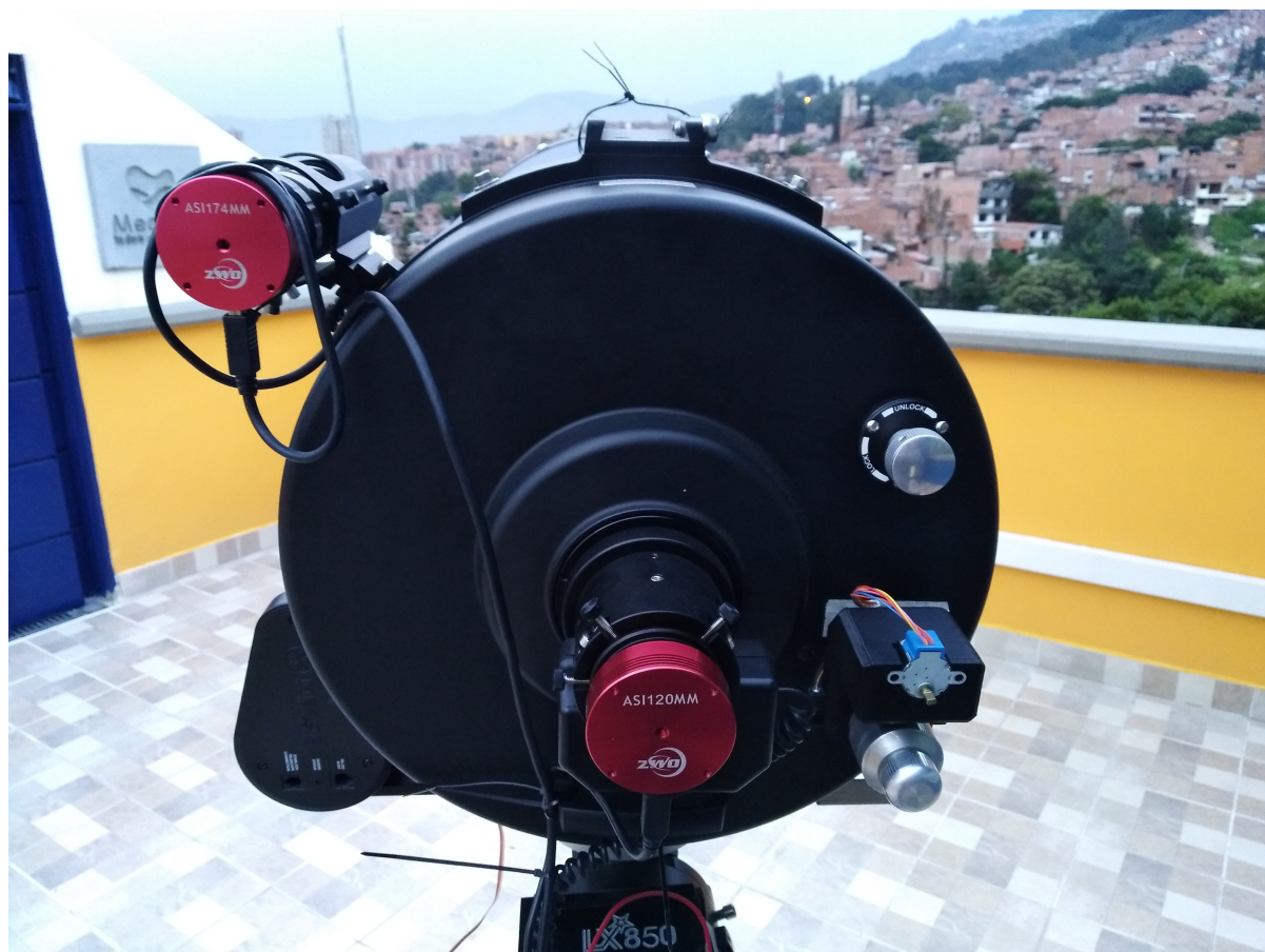
Figura 49: Configuración de las cámaras ZWO usadas, una como cámara principal (ASI120) y la otra como cámara del buscador(ASI174).
