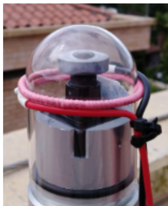
Figura 73: Solución al problema de condensación, en la cual se uso: una resistencia que se conecta por USB para calentar el domo, una bolsa de gel de sílice para absorber la humedad y cinta adhesiva para sellar el espacio entre el domo y el soporte.
