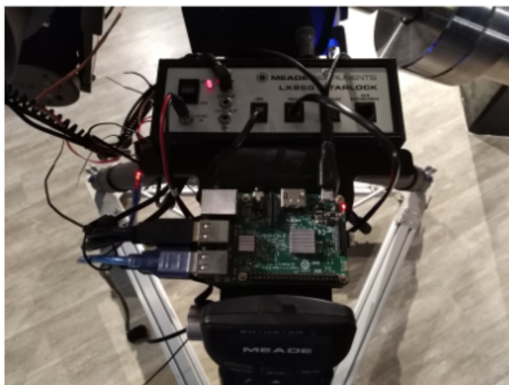
Figura 107: Sistema de control basado en StellarMate (Ubuntu Mate + KStars + INDI) para el control de telescopio, cámaras y accesorios.
