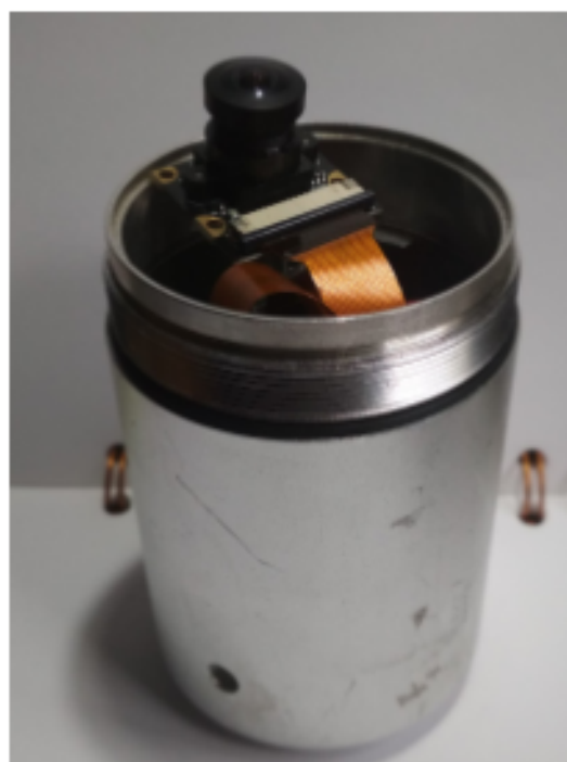
Figura 117: Montaje físico de la cámara de vigilancia basada en Raspberry Pi.
