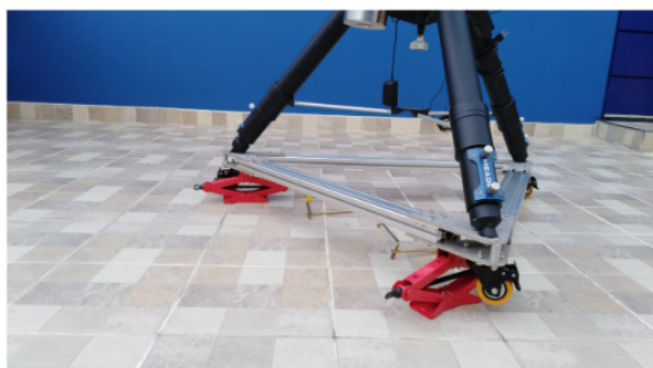
Figura 45: Detalle de la ubicación de los gatos mecánicos.
