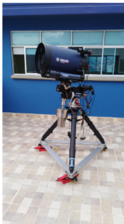
Figura 47: Montaje del telescopio orientado al norte y nivelado.
