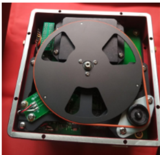
Figura 51: Cámara sin cubierta frontal, se aprecia el disco obturador.
