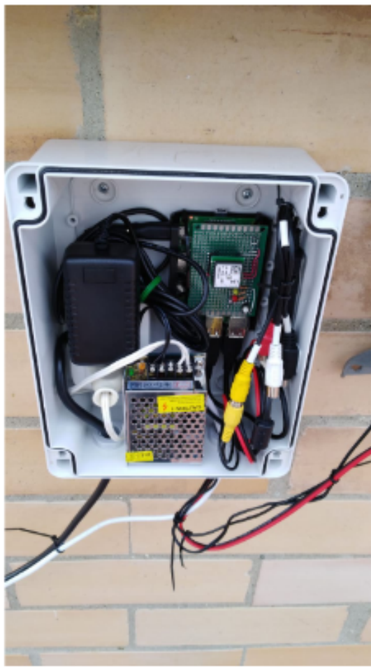
Figura 62: Caja de control de la cámara de cielo con Raspberry Pi instalada en la sede de oriente de la UdeA.
