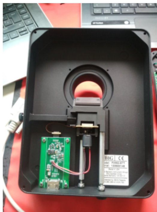
Figura 57: Cubierta de la rueda de filtros con CCD guía.
