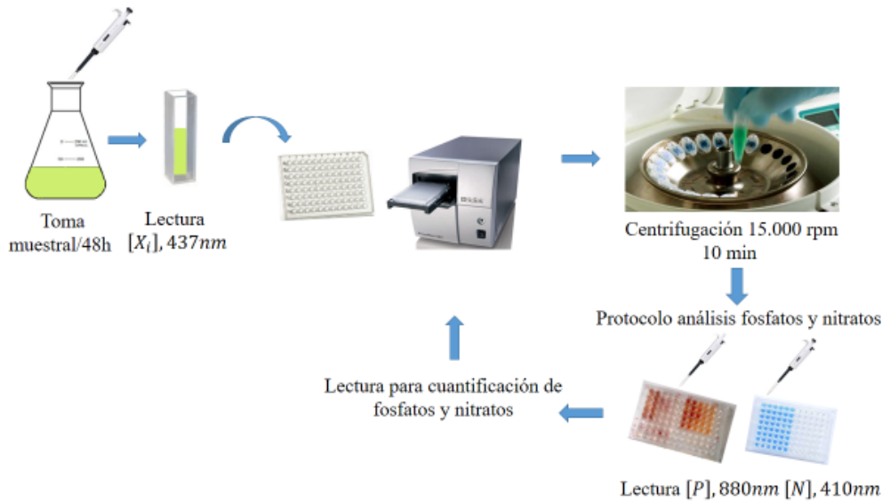
Figura 2.5: Esquema medición biomasa, fosfatos y nitratos. a) toma de muestras b) lectura de biomasa, c) centrifugación de las muestras, d) protocolo análisis para cuantificación de fosfatos y nitratos.
