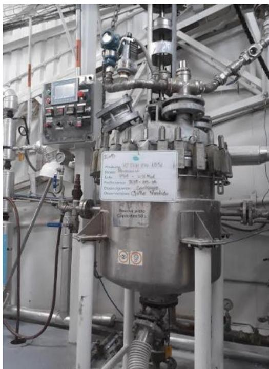
**Figura 5. Reactor piloto (capacidad de 50L) de la empresa New Stetic S.A.**
