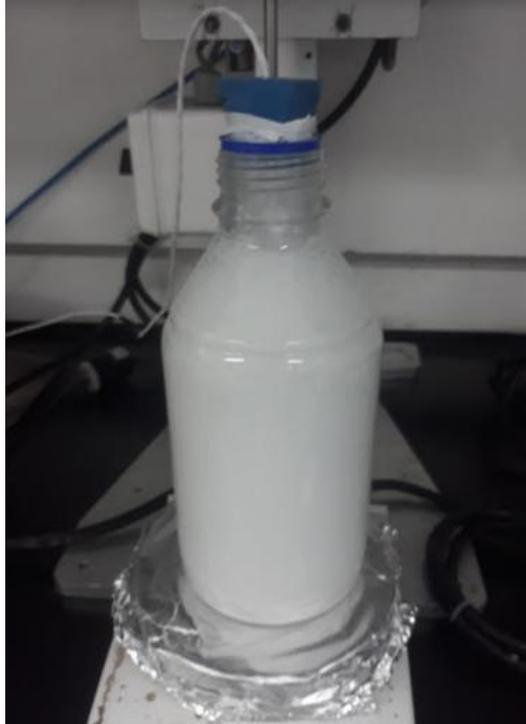
**Figura 6. Reactor del laboratorio (capacidad 1L) en la empresa New Stetic S.A.**
