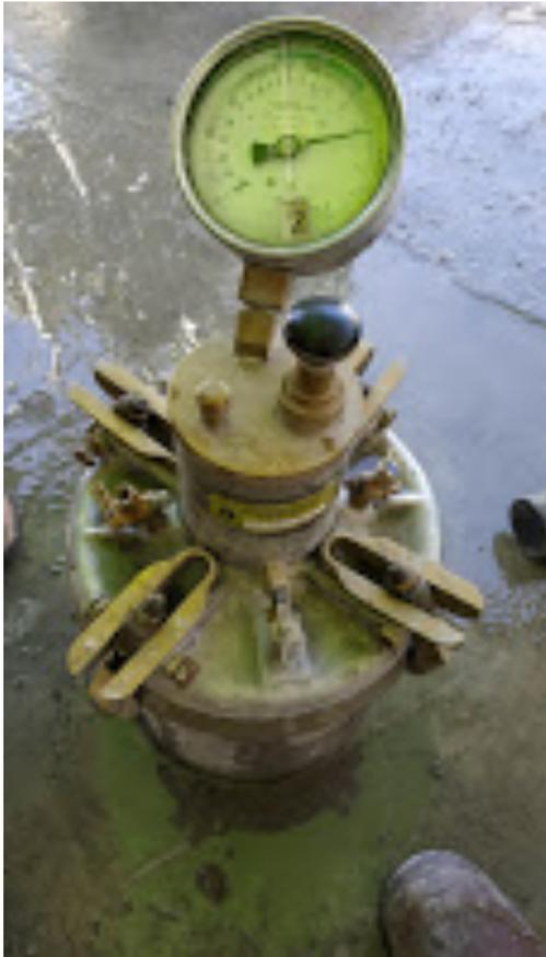
**Ilustración 8.** Prueba de contenido de aire.
