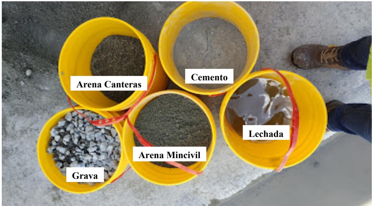
**Ilustración 5.** Materiales usados para los ensayos de concreto. **Fuente:** Elaboración propia.
