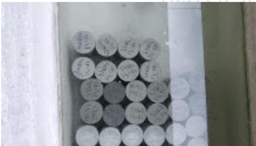
**Ilustración 10.** Almacenamiento de cilindros. **Fuente:** elaboración propia.
