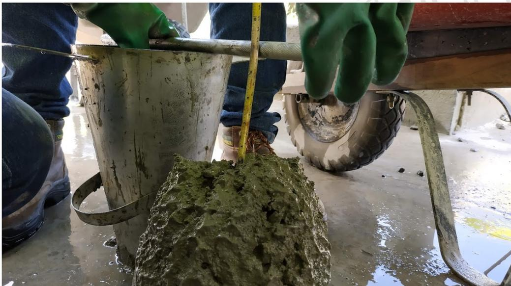
**Ilustración 7.** Prueba de asentamiento. **Fuente:** Elaboración propia.
