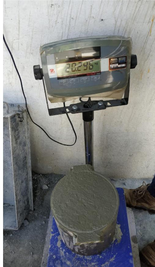
**Ilustración 9.** Prueba de rendimiento volumétrico. **Fuente:** Elaboración propia.
