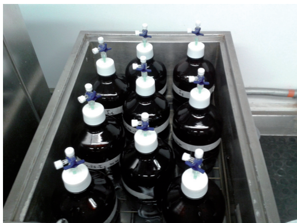
Figura 1. Montaje experimental utilizado en los ensayos de PMB.
