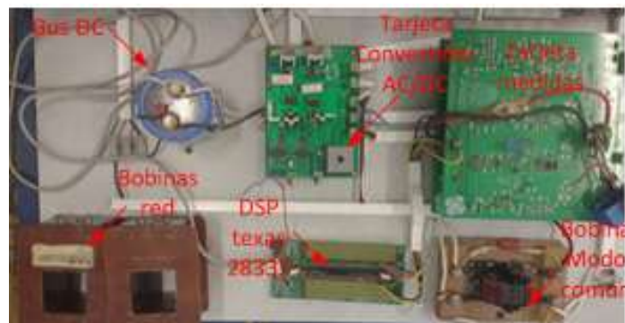
Fig 4. Prototipo convertidor AC/DC implementado.
