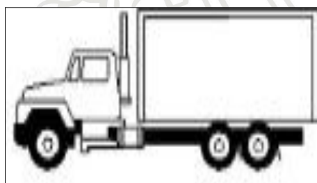
Ilustración 5 Camión de dos ejes (C2). Fuente: Clasificación vehicular del MTI (S.F). Recuperado de http://bit.ly/2SX2mQ7
