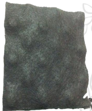
Ilustración 2: Geomembrana nodular Lamidren L7 - Con geotextil.
