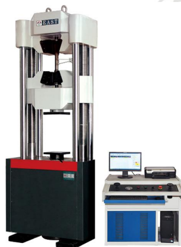
Ilustración 7: Máquina universal de ensayos (WAW100). ("Máquina universal de ensayos hidráulica, Máquina de prueba," n.d.).
