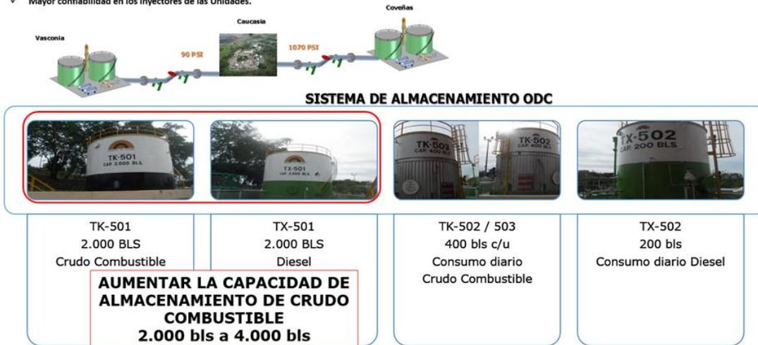
Ilustración 5. Tanques del Sistema de Combustible de la Planta Caucaasia ODC. Fuente propia
