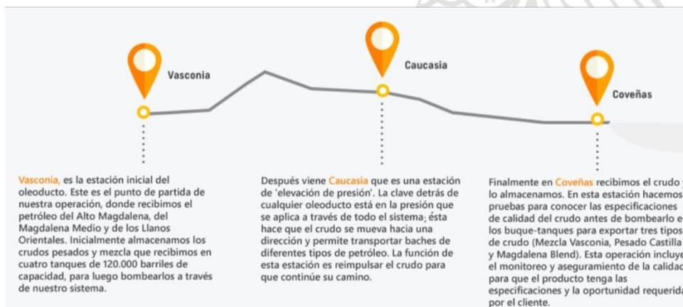
Ilustración 2 Esquema ODC. Fuente: Oleoductodecolombia.com
