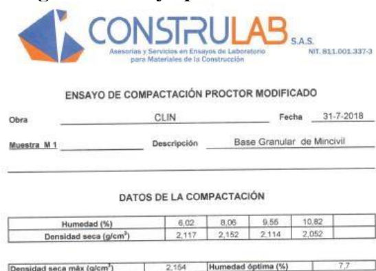
Imagen 13. Ensayo proctor modificado Imagen 14. Ensayo proctor modificado
