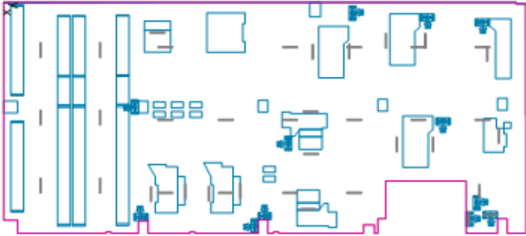
Plano útil 1: Intensidad lumínica perpendicular (Adaptativamente) (Superficie) Escena de luz: Escena de luz 1 Media: 176 lx (Nominal: \geq 500 lx), Min: 0.006 lx, Max: 553 lx, Mín./medio: 0.000, Mín./máx.: 0.000 Altura: 0.000 m, Zona marginal: 0.000 m
