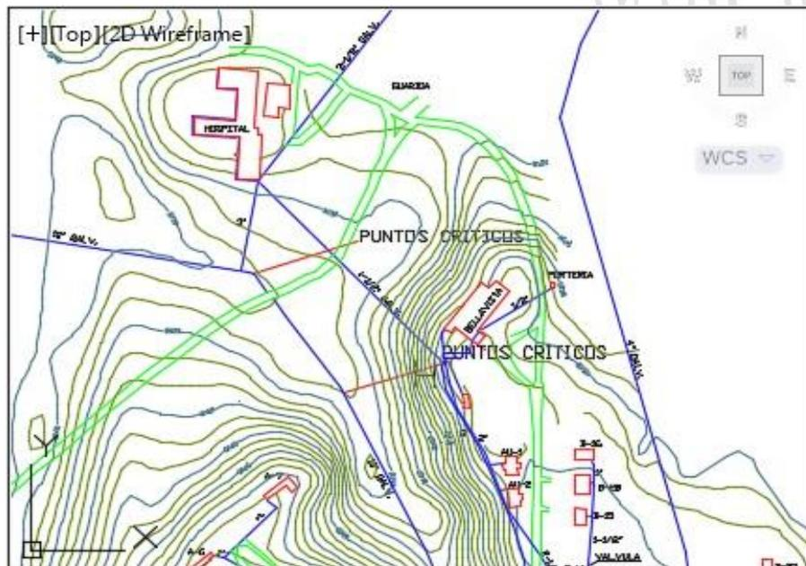
**Imagen 8.** Plano de los puntos críticos de las zonas con mayor presión en la distribución de agua potable.
