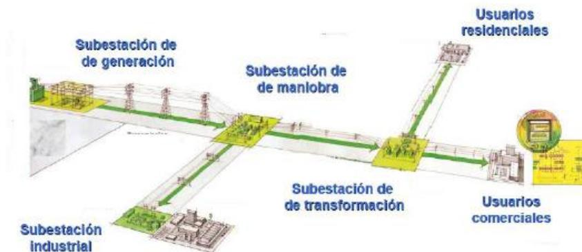
**Figura 7** Tipos de subestaciones eléctricas.
