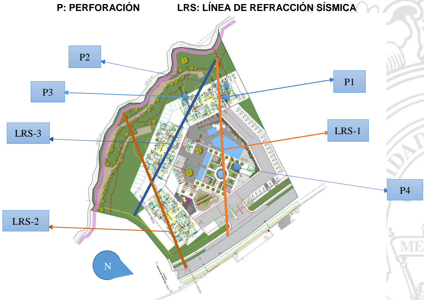
Ilustración 4. Ubicación de perforaciones realizadas con S.P.T y equipo de rotación
