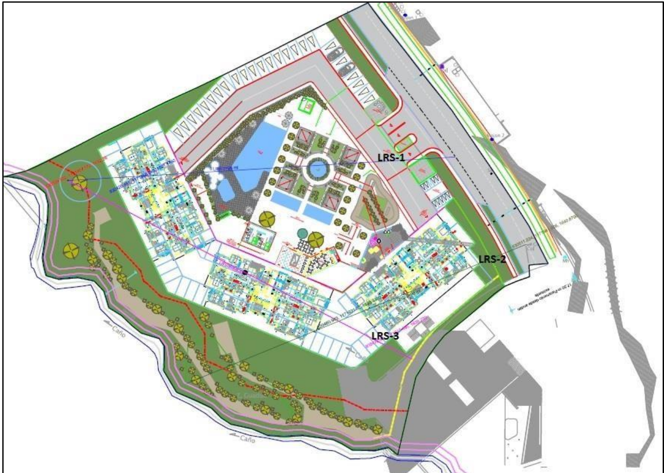
Figura 4 Ubicación de las líneas de refracción sísmica en el Proyecto Paris.
