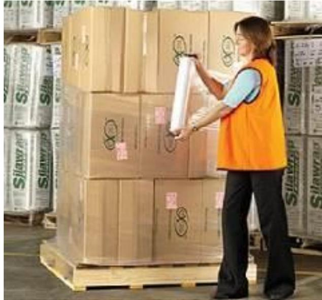
Ilustración 1: Uso manual del Plástico para paletizar (Fuente: <https://adelplast.com/caracteristicas-film-estirable>)
