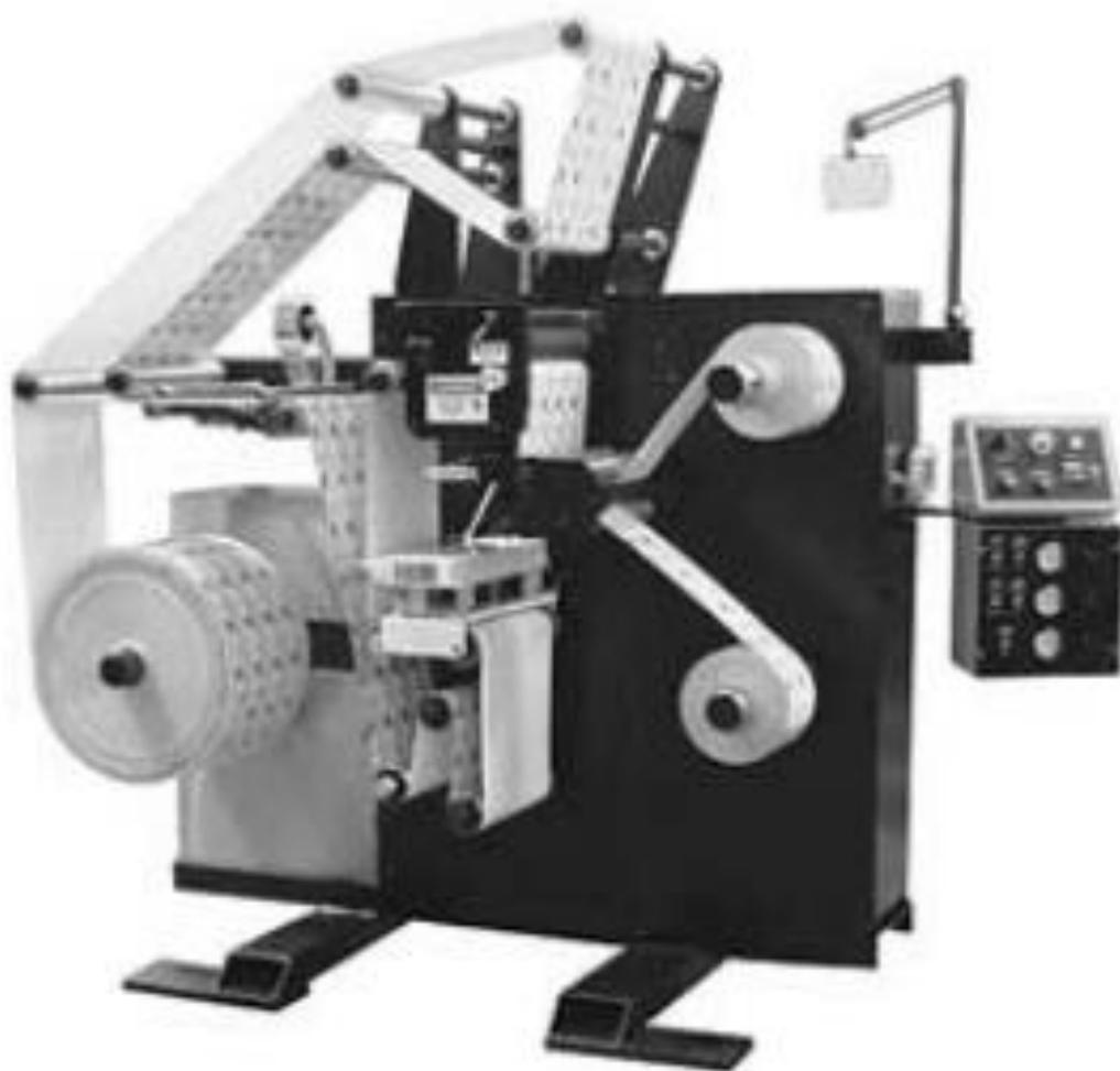
Ilustración 4:Maquina rebobinadora horizontal lateral (Fuente: [www.aztechmachinery.com](http://www.aztechmachinery.com))
