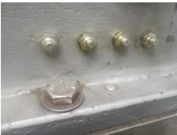
Imagen 8: Sistema centralizado de lubricación con pistola. Fuente: autor.
