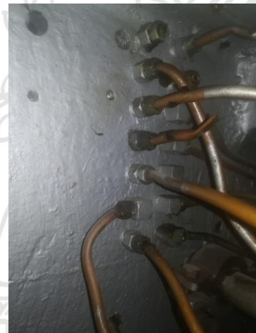
Imagen 8: Sistema centralizado de lubricación con pistola. Fuente: autor.
