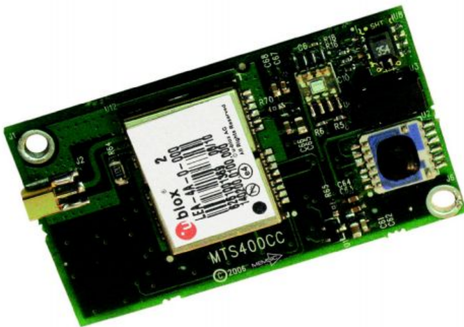
Fig. 2 . Sensor MTS400CC el cual mide 5 parámetros ambientales.
