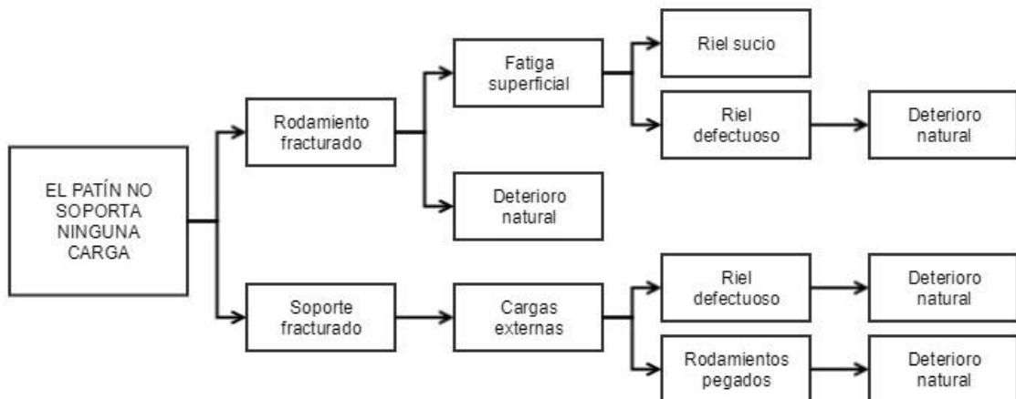
Diagrama 16. Análisis causa-raíz: El patín no soporta ninguna carga.
