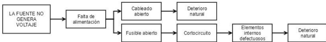
Diagrama 20. Análisis causa-raíz: La fuente no genera voltaje.
