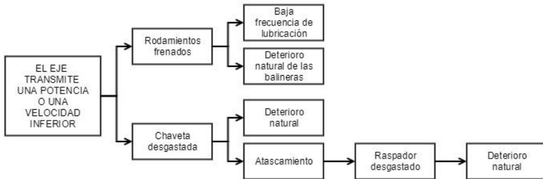
Diagrama 8. Análisis causa-raíz: El eje transmite una potencia o velocidad inferior.
