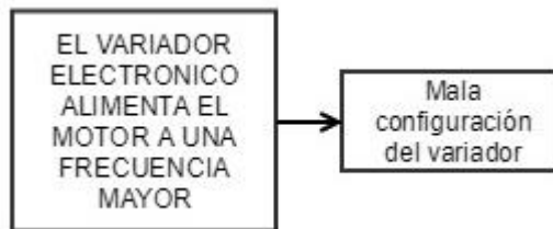
Diagrama 13. Análisis causa-raíz: El variador electrónico alimenta el motor a una frecuencia mayor.
