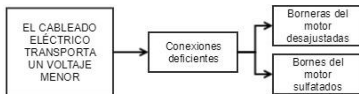
Diagrama 18. Análisis causa-raíz: El cableado transporta un voltaje menor.
