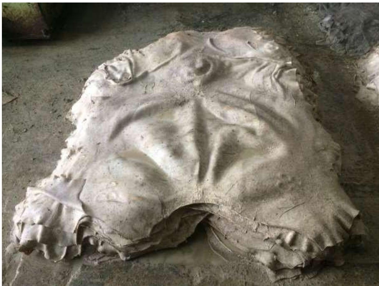
Fotografía 1. Pieles después del descarne y antes del curtido
