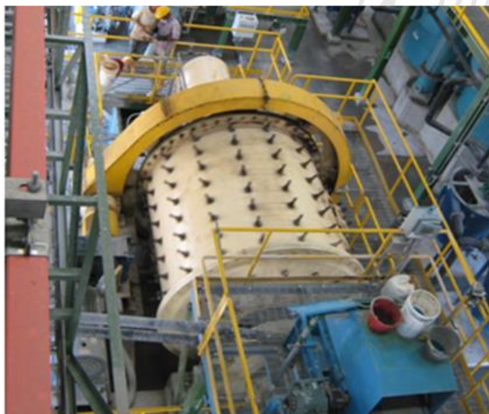
Figura 2. Molino 8'x8' utilizado en la etapa de molienda.
