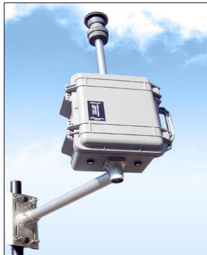
Figura 18. Muestreador de bajo volumen MiniVol Tactical Air Sampler (TAS) para la determinación de PM_{10} por método gravimétrico. Cortesía de Airmetrics.
