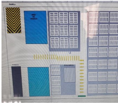
Fotografía 75. Proyección de señalización de rutas peatonales y demarcación.
