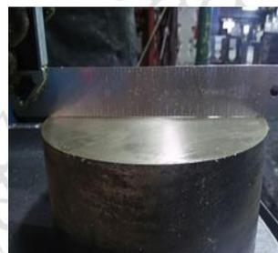
**Fig.6.** Muestra de lingote para análisis composición química y ensayo de dureza
