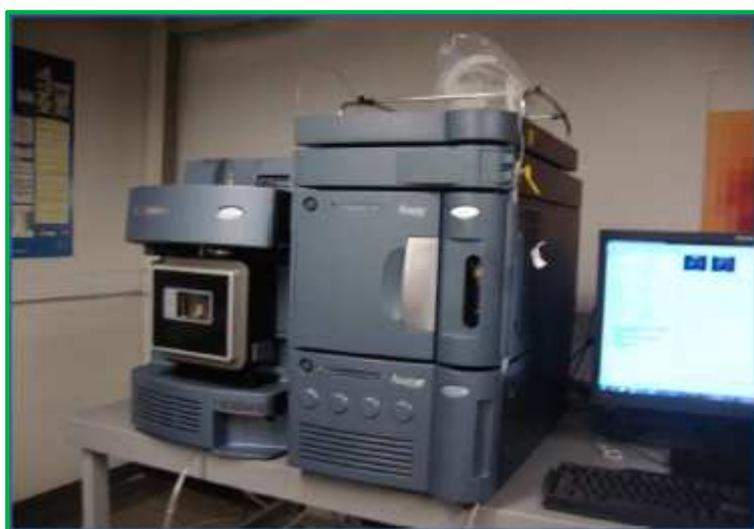
**Figura 16 Sistema UHPLC/MS/MS (Fuente propia).**
