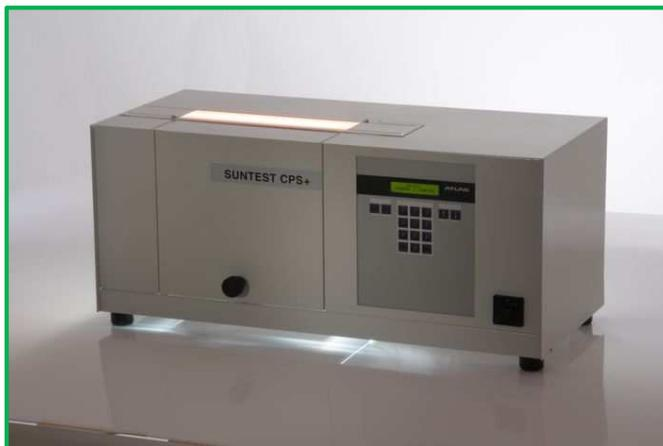
**Figura 13 Equipo Suntest CPS+ (Fuente: Atlas Materials)**
