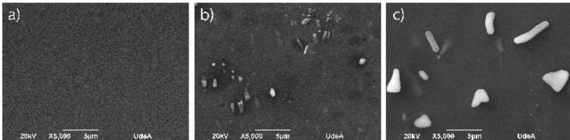
*Figura 4. Micrografías SEM-SE (electrones retrodispersados sigla en inglés) de la topografía de la superficie de las muestras después del proceso de electropulido en dos etapas para las tres aleaciones de aluminio diferentes: (a) Al 5N, (b) Al 1100 y (c) Al 8005. Reimpreso con permiso de © 2018 Elsevier.*
