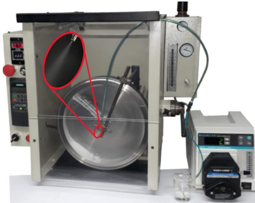
Figura 2-4. Peletizador en tambor rotatorio con detalle de la boquilla. Cortesía del Ing. Jhoman Alberto Arias.
