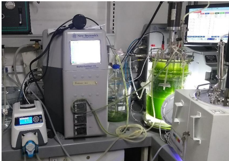
Ilustración 3.2. Sistema en continuo de Botryococcus braunii
