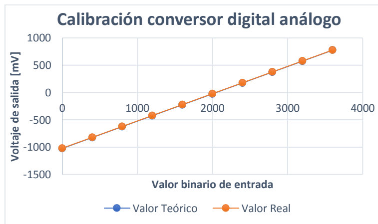
Figura 37. Gráfica de comparación del valor teórico y el valor real de la salida del DAC.
