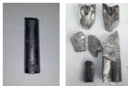
Figura 9. Lingotes homogéneos de la aleación Fe 77 Si 8 B 10 P 5 , usados para la obtención de cintas de metal amorfo
