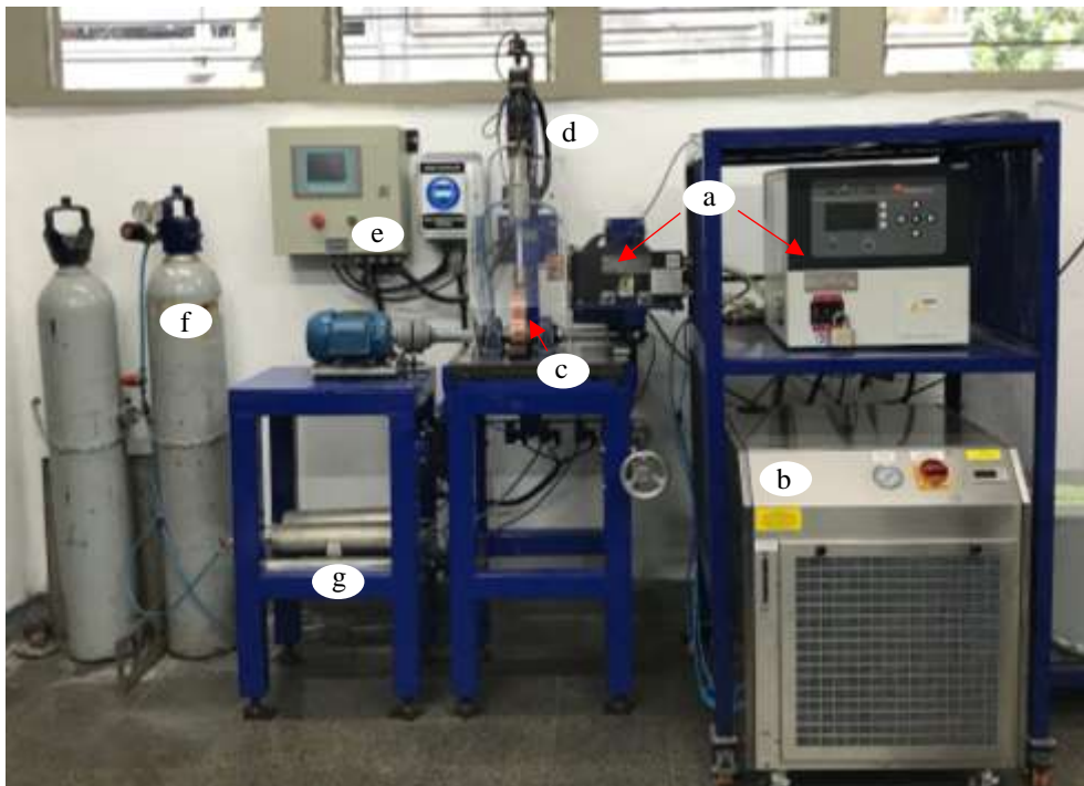
Figura 10. “ Melt-spinner ” ubicado en las instalaciones de la Universidad de Antioquia a. Horno de inducción. b. Sistema de refrigeración. c. Rueda de cobre. d. Sensor de temperatura. e. PLC. f. Cilindro de Argón. g. Cilindros para sobrepresión
