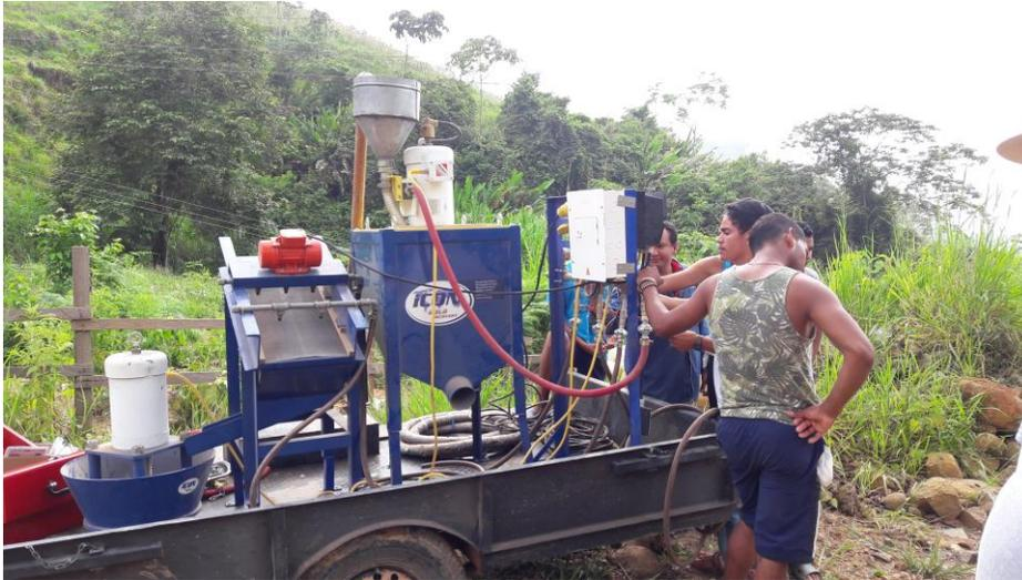
**Ilustración 5. Máquina "agroecológica" para la extracción de oro sin usar mercurio ni cianuro. Casa de Barro. Norosí. 2016**
