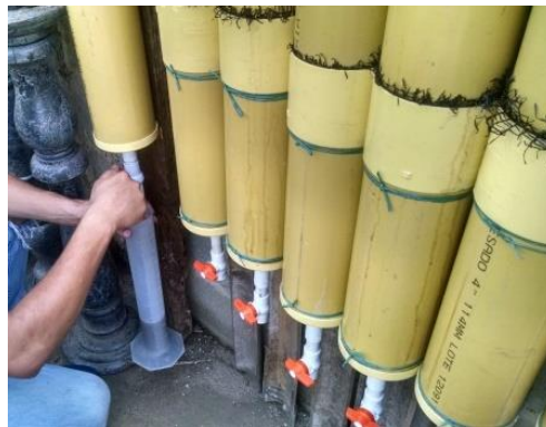
Imagen 5. Extracción de percolado
