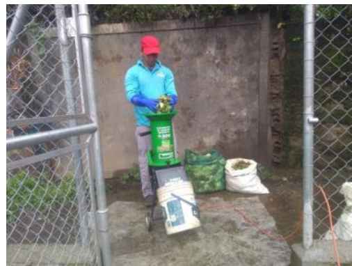
Imagen 15. Proceso de picado de los residuos orgánicos
