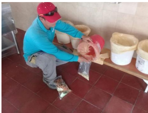
Imagen 39. Proceso de aforo de residuos sólidos orgánicos
