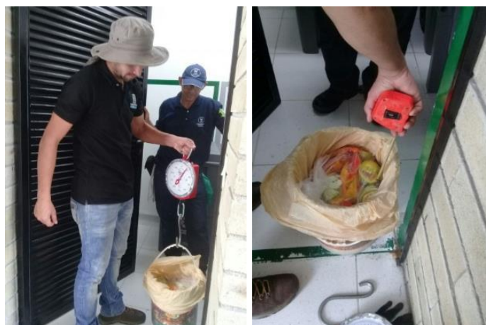
Imagen 38. Proceso de aforo de residuos sólidos orgánicos
