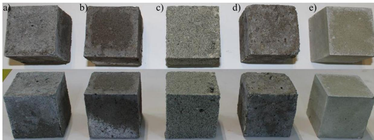
**Figura 5-3.** Eflorescencia en las muestras preparadas con la combinación  $M_s=0,5\text{-}\%Na_2O=12$ , mostrando la vista superior y lateral de las muestras. a) MRCdm0, b) MRC, c) MCF, d) MRCm0 y e) MCFm0.
