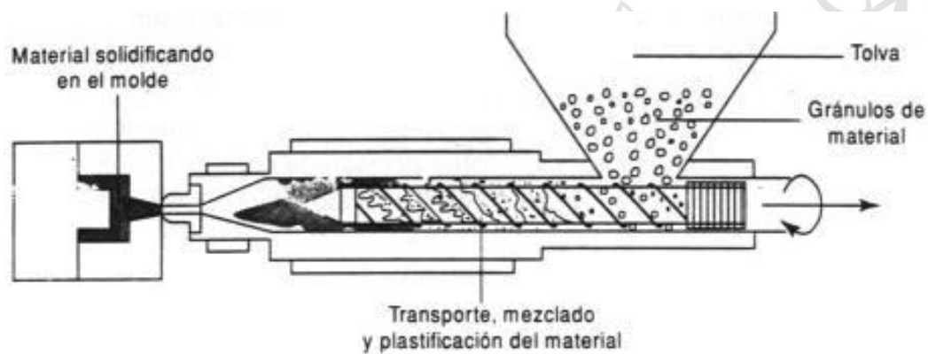
Ilustración 3. Proceso de Inyección de plástico
