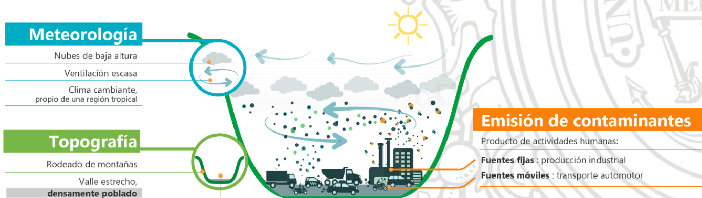
Ilustración 4. Factores que aumentan la concentración de contaminantes atmosféricos en el Área Metropolitana del Valle de Aburrá
