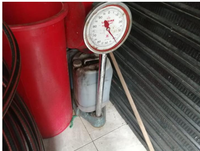
Figura 28. Báscula para el pesaje de residuos. Unidad residencial Aparta Casas Aliadas Zona A.
